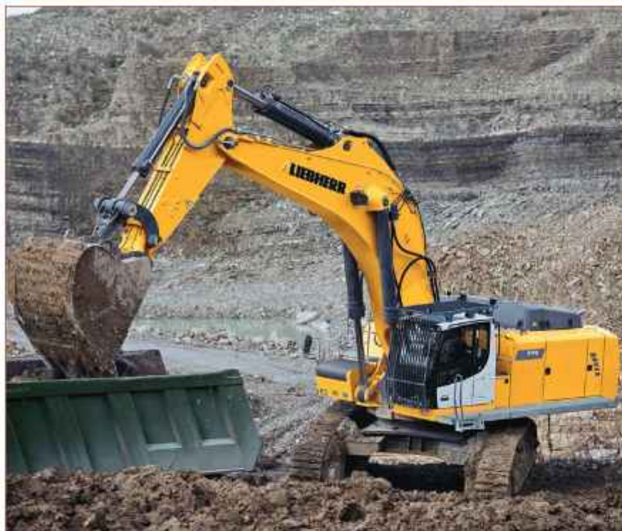
Верижан багер Liebherr R992 с работна маса 92 t и дизелов двигател с мощност 571 к.с.
