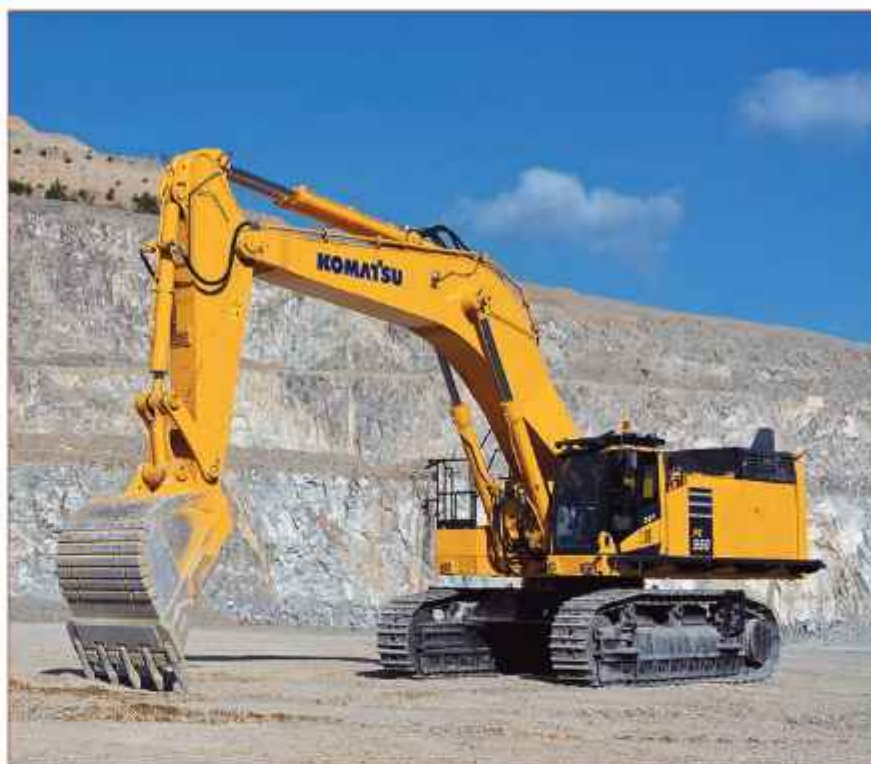
Верижен багер Komatsu PC950-11 с работна маса 95 t и дизелов двигател с мощност 543 к.с.
