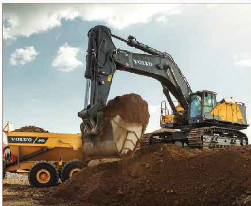
Вериген багер Volvo EC950F с работна маса 95 t и дизелов двигател с мощност 611 к.с.
