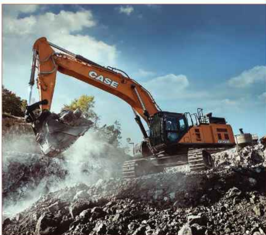
Верижен багер Case CX750D с работна маса 72 t и дизелов двигател с мощност 512 к.с.
