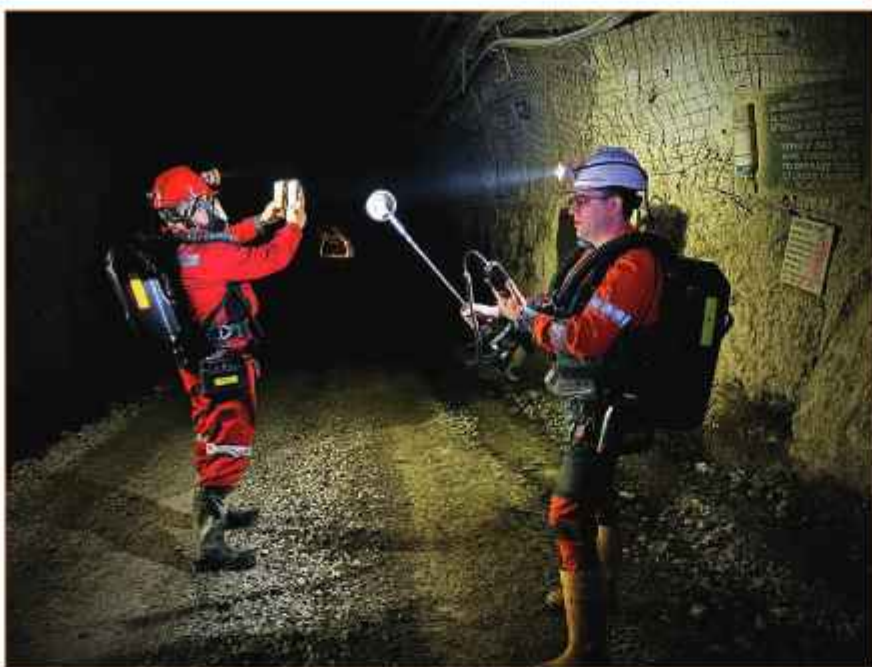
Измерване на скорост на вентилационната струя и концентрации на газове, при реверсивен режим, с участие на екипи в рудника
