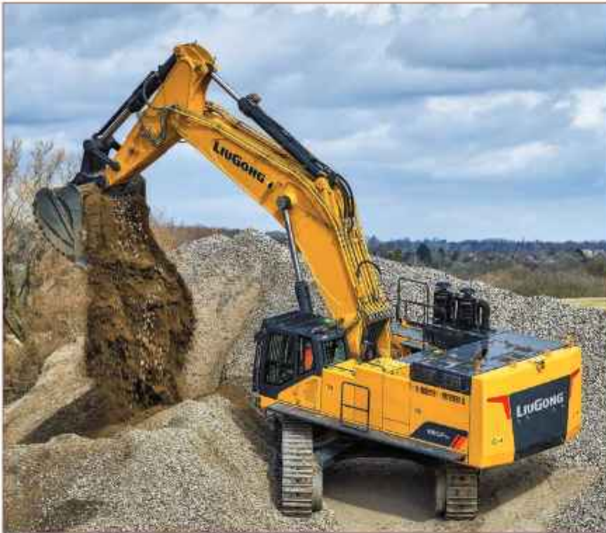
Верижен багер Liugong 995F с работна маса 95 t и дизелов двигател с мощност 600 к.с.
