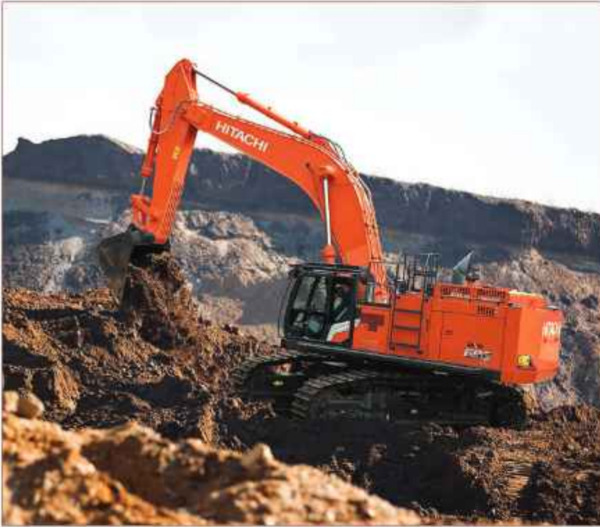
Верижен багер Hitachi ZX690LCH-7 с работна маса 70 t и дизелов двигател с мощност 473 к.с.
