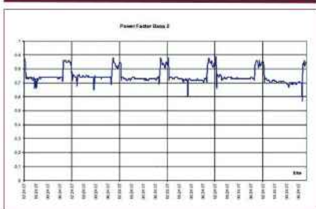
Фиг. 8. Изменението във времето на \cos \varphi на секция 2 на шини 6 kV на подстанцията ГПП 110/20/6 kV
