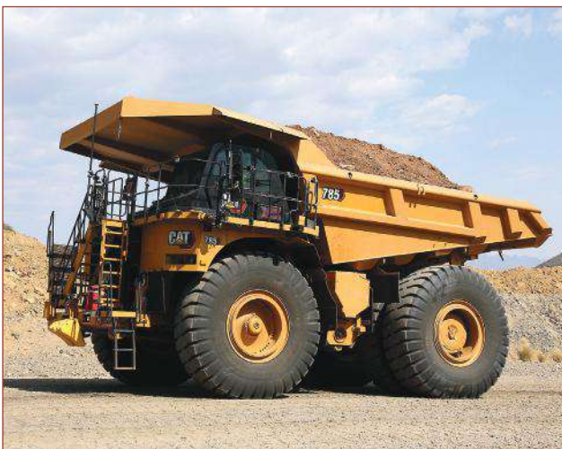
Нов модел минен самосвал Cat® 785 Next Generation с полезен товар 139 т / 142 т
