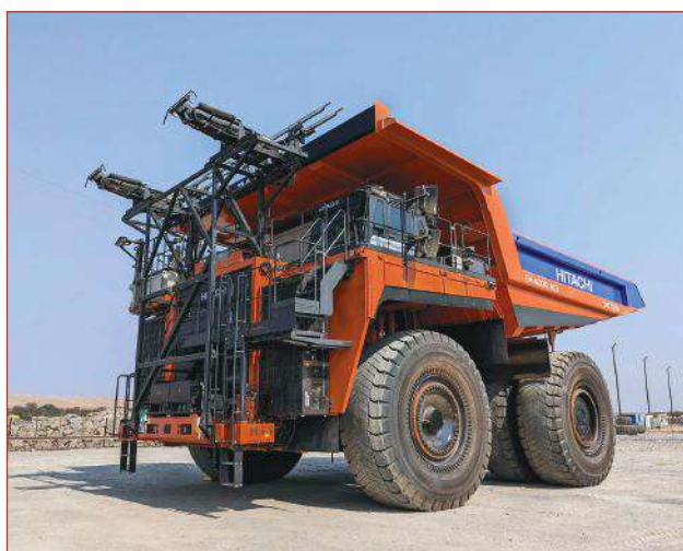
Електрически минен самосвал Hitachi EH4000AC-3 BATTERY с тягови батерии и полезен товар 221 т
