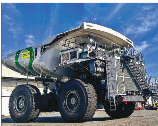
Електрически минен самосвал Liebherr Europa с водородни горивни клетки и полезен товар 240 t
