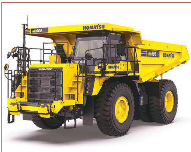
Нов модел минен самосвал Komatsu HD605-10 с полезен товар 64 t
