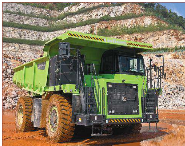
Нов модел електрически минен самосвал LiuGong DR50C-E с тягови батерии и полезен товар 45 t
