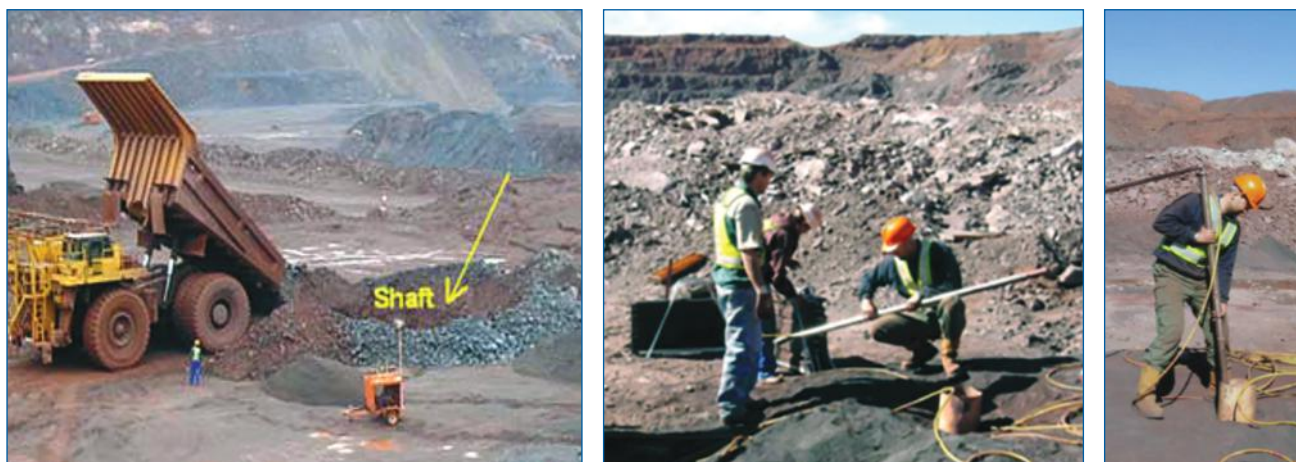
Фиг. 2. Устието на шахтата, използвана за запълване на пещерата и подготовка и поетапно спускане на Carlson C-ALS Gyro в сондажа
