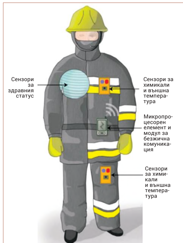
Фиг. 2. Схема на пожарозащитно облекло с вградени сензори
