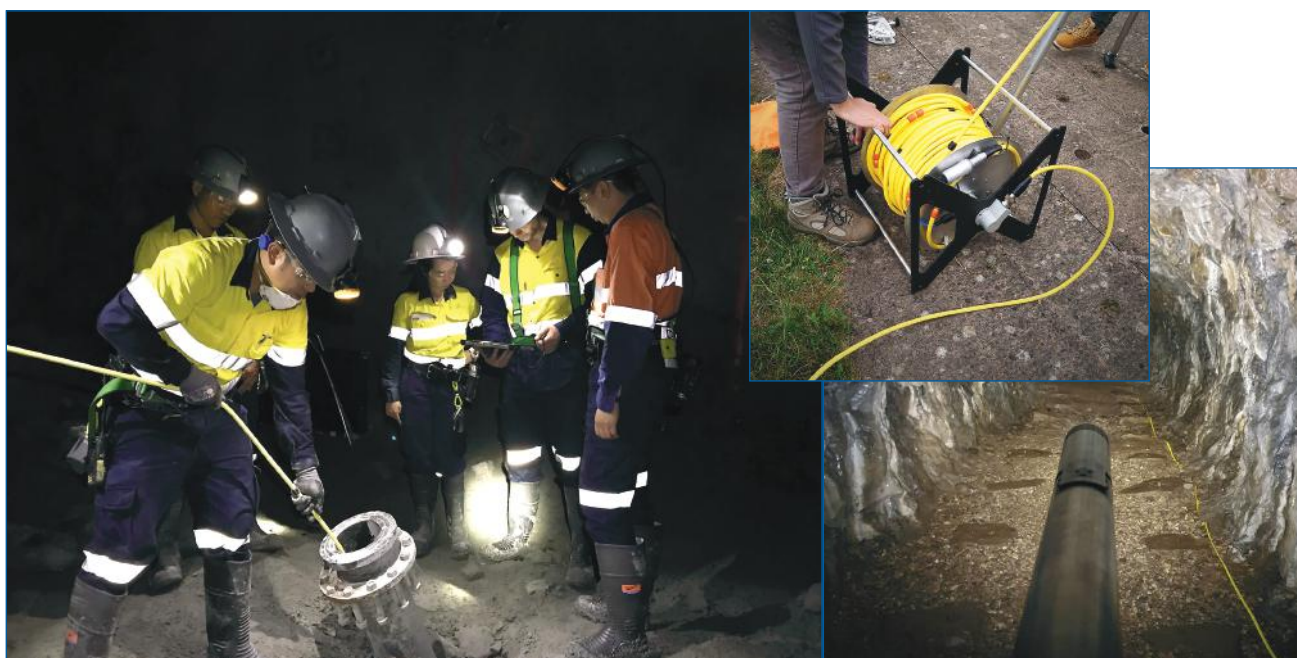
Фиг. 7. Скенерът Carlson C-ALS Gyro се подава до камерата през предварително прокаран сондаж за достъп
